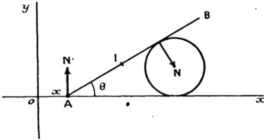
La méthode analytique donne alors deux équations exprimant l'invariance de  $\frac{\partial T}{\partial \varphi'}$  et  $\frac{\partial T}{\partial \theta'}$ . La vitesse angulaire  $\varphi'$  n'est pas altérée. Quant à  $\theta'$ , elle prend une valeur  $\theta'_1$  définie par l'équation
