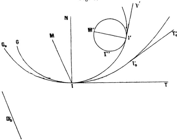
est en  $I$ , le point de contact  $M$  de  $C$  et du rouleau doit être tel (n° 2) que  $IM$  soit parallèle à  $D_0$ , et il faut en outre que la projection du déplacement infinitésimal du point  $I$  sur la tangente à la trajectoire du point  $M$  soit moitié du déplacement de ce dernier point.
