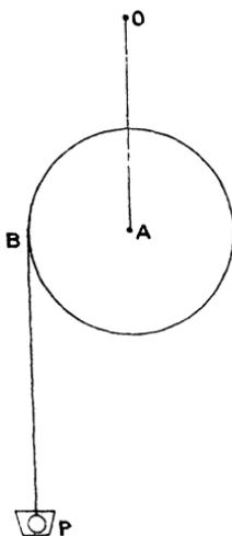
*il peut tourner, à un point fixe O, au moyen de deux fils élastiques égaux qui s'allongent proportionnellement à leur tension. Sur la circonférence du disque est enroulé un fil flexible et inextensible qui porte à son extrémité un poids P.*
