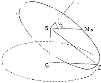
*Une roue circulaire dont le rayon est égal à la génératrice SB du cône porte à sa circonférence un canal annulaire de très petite section, dans l'intérieur duquel on a introduit une sphère homogène pesante de masse  $m$ , d'un très petit diamètre égal à celui du canal et qui peut glisser sans frottement dans ce canal.*
