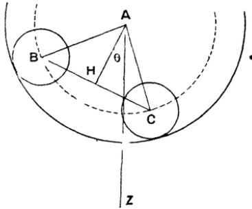
se mouvoir dans un plan vertical fixe. En B et C sont implantés, normalement au plan du triangle, deux clous de masses et de dimensions négligeables. Chacun de ces clous est l'axe de deux roues planes infiniment minces, circulaires, pesantes, qui lui sont normales et qui sont équidistantes du plan du triangle.
