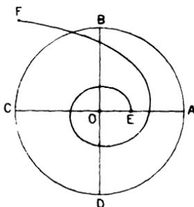
des aiguilles d'une montre à partir de la position d'équilibre. Le ressort exerce alors sur le bras du volant un effort perpendiculaire de  $f$  grammes.
