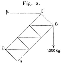
une tige CE, laquelle est articulée en un point fixe E choisi de façon que la poutre soit inclinée à  $45^\circ$  et que la tige CE soit horizontale. Déterminer les réactions et tensions du système sous l'action d'un poids de  $1000\text{kg}$  attaché en B en négligeant le poids propre des barres.
