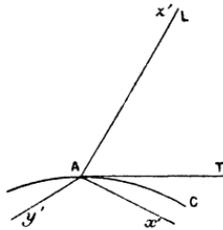
la ligne de striction dans le sens des arcs croissants; prenons  $Ax'$  dans le plan de AT et de  $Az'$  et du même côté de  $Az'$  que AT; enfin  $Ay'$  sera perpendiculaire au plan  $Ax'z'$  de façon que le trièdre  $Ax'y'z'$  ait même sens que le trièdre des axes fixes.
