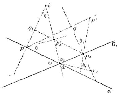
plans verticaux passant par  $G$  et  $G_1$ . Le plan tangent en  $a$  est défini par les génératrices  $G$  et  $ap_1$ , en  $a_1$  par les génératrices  $G_1$  et  $a_1p$ ,
