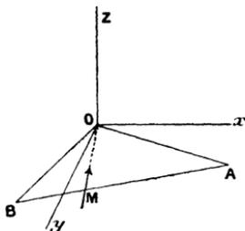
voir sur l'hypoténuse  $AB$ . On demande de déterminer le mouvement du système formé du triangle  $AOB$  et du point  $M$  en négligeant les frottements, et en supposant que le point  $M$  est attiré par le point  $O$  de l'axe fixe proportionnellement à sa distance à ce point.
