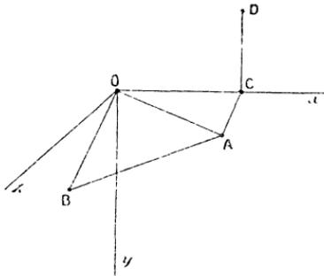
tique DCA, dont une extrémité D est fixe, soutient à son autre extrémité le triangle AOB auquel il est attaché en A. Ce fil passe en outre dans un anneau très petit C situé sur l'horizontale Ox, à une distance OC du point O égale à OA.
