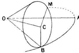
2<sup>o</sup> *Un cône droit dont l'angle est  $2\beta$  est chargé d'un poids M appliqué en un point de sa surface. Déterminer le mouvement de ce point quand on écarte le cône de sa position d'équilibre. On suppose le cône sans masse et assujetti à rouler sur un plan horizontal.*
