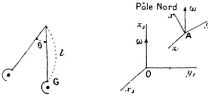
2° Étudions le mouvement d'un projectile à la surface de la Terre, lancé avec la vitesse  $v_0$  dans un plan vertical. Nous prenons comme axes fixes des axes passant par le centre de la Terre,  $Oz$ , vers le pôle nord, de
