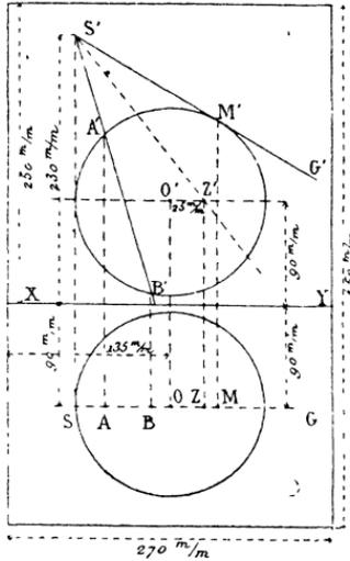
plan horizontal de projection. L'axe de ce cône est une droite de front ( $sz, s'z'$ ) qui rencontre le diamètre de la sphère parallèle à la ligne de terre en un point ( $z, z'$ ) situé à droite de  $O$  et à une distance de  $25^{\text{mm}}$ . La génératrice de front ( $sg, s'g'$ ) du cône s'obtient en menant de ( $s, s'$ ) une tangente au grand cercle de front de la sphère dont le contact a lieu en ( $m, m'$ ).
