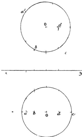
Le centre de la sphere est projete en  $O, O'$ , les points  $o$  et  $o'$  sont à  $0^m,102$  de la ligne de terre et la droite  $OO'$  est au milieu de la feuille, le rayon de la sphere a  $0^m,092$  de longueur
