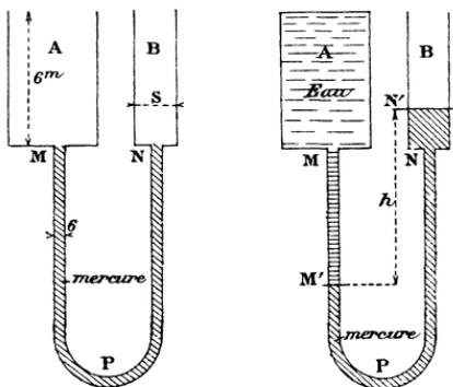
rempli: l'eau refoule le mercure du tube en  $M'$  d'un côté, en  $N'$  de l'autre.
