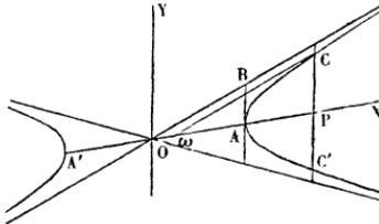
conjugué de sa direction; d'après le théorème de Newton et pour tous les points de la courbe, le rapport  $\frac{PC \times PC'}{PA \times PA'}$  a une valeur constante, et il en est de même de  $\frac{\overline{PC}^2}{PA \times PA'}$ , puisque  $PC = PC'$ .
