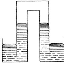
entre les deux cylindres est rempli partie par de l'air, partie par du mercure; et le système se trouve ainsi en équilibre pour une pression atmosphérique donnée.
