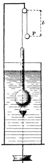
d'un mouvement uniforme autour de son axe de figure supposé vertical; une potence liée à l'éprouvette supporte sans frottement une poulie de dimensions négligeables, placée exactement sur l'axe de rotation. Un poids P (25<sup>g</sup>) est attaché à un bout d'un fil non pesant qui passe sur la poulie et vient s'attacher par l'autre bout à un aréomètre dont la tige a une section de 1<sup>cm</sup>. Section droite de l'éprouvette : 10<sup>cm</sup>.
