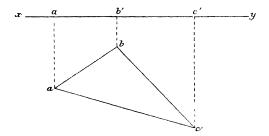
tal:  $aa' = 84^{\text{mm}}$ ,  $a'b' = 99^{\text{mm}}$ ,  $ab = 112^{\text{mm}}$ ,  $bc = 144^{\text{mm}}$ ,  $ac = 171^{\text{mm}}$ . L'arète SA parallèle au plan vertical égale
