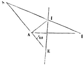
point A est fixe, l'angle S se meut sur la circonférence de rayon SB et de centre B: donc le centre instantané de rotation est à l'intersection de la droite SB et de la perpendiculaire menée par le point A à SA. Cela posé, la longueur SE étant constante, la normale au lieu du point E est précisément IE.
