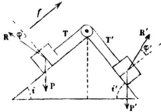
retient, et, si l'on tient compte du frottement, la réaction  $R$  du plan, qui est incliné sur la normale aux surfaces apparentes, et en sens inverse du mouvement, d'un angle  $\alpha = \arctang f$ ,  $f$  étant le coefficient du frottement relatif aux substances en contact.
