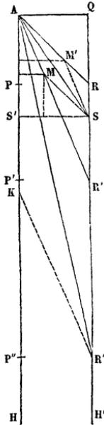
forces égales et obliques  $AR, PP'$  appliquées au point  $A$  et représentées par les côtés du losange dont  $AR'$  est la diagonale et l'angle aigu  $PAR$ . La même démonstration s'applique à la diagonale  $AR''$ .
