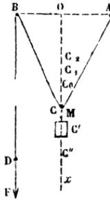
une époque quelconque dans une position  $C$  sur  $Ox$ , avec une vitesse acquise suivant cette droite; il ne doit pas s'en écarter, car la résultante de  $mg$  et des forces égales à  $mf$  agissant alors suivant  $CA$ ,  $CB$ , qui font varier le mouvement, est toujours dirigée suivant  $Ox$ . Le mouvement commencé sur  $Ox$  continuera donc sur cette droite, soit dans le sens de la pesanteur, soit dans le sens opposé.
