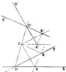
l'angle  $\theta'$  et qu'on fasse tourner ce segment autour de  $AB$ , le point  $C$ , centre de la perspective, est quelque part sur cette surface. D'ailleurs, un plan  $A'CB'$  mené par le point  $C$  parallèlement au plan des  $xy$  doit couper le plan des  $X'Y'$  selon une droite  $A'B'$  dont les points se projettent à l'infini sur le premier des deux, c'est-à-dire selon la droite dont l'équation est
