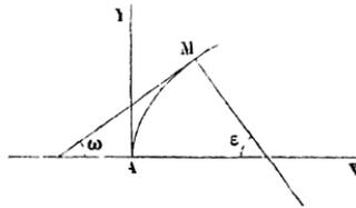
soit M un point variable dont les coordonnées sont  $x$  et  $y$ . En appelant  $\omega$  l'angle que la tangente en M fait avec l'axe des  $x$ , et  $s$  l'arc de courbe, on a
