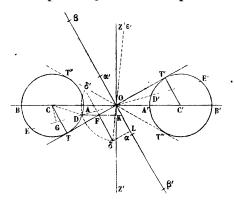
cercles dont CA et C'A' sont les rayons, la section de la surface par ce plan méridien. La perpendiculaire ZZ' à la droite CC' en son milieu O sera l'axe de la surface. Soit TT' la trace du plan tangent donné. Rabattons ce plan sur le plan de la figure autour de TT'.
