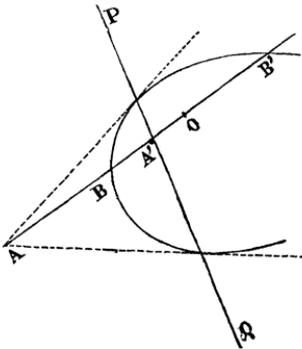
Lorsque d'un point  $A$ , pris à volonté dans le plan d'une conique, on mène une transversale quelconque  $ABB'$ , on sait que le point  $A'$  où cette transversale rencontre la polaire  $PQ$  du point  $A$ , est le conjugué harmonique du point  $A$  par rapport aux extrémités  $B, B'$  de la corde  $BB'$ ; cette propriété s'exprime par la relation
