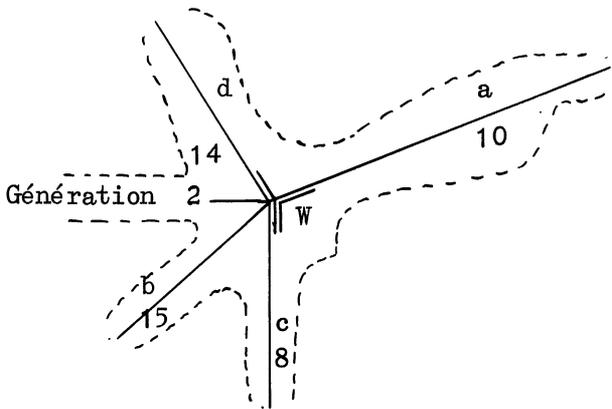
Décisions en W d'aiguiller d sur c et a sur c.
