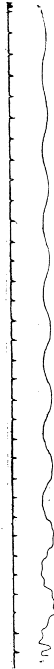
FIG. 13. — Augmentation de la période apparente d'une conduite sous l'influence d'une poche d'air située à l'extrémité aval; expérience US-P s -46-22.
