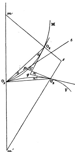
Après un déplacement infiniment petit de la courbe M, le point  $O_2$  vient en  $O_2'$  sur la courbe F et devient le centre instantané de rotation. Le faisceau de droites, dont le sommet est en  $O_2'$ , est maintenant l'ensemble des normales aux trajectoires des points de la conique C. Les points de rencontre des droites du faisceau  $O_2'$  et du faisceau  $O_1$  sont alors les centres de courbure des trajectoires décrites par les points de la conique C, et, comme ces fais-
